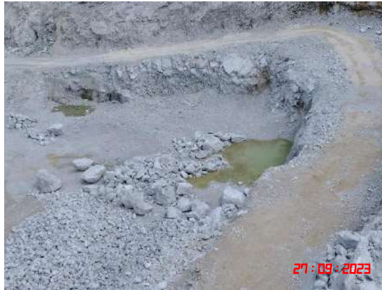
บ่อรับน้ำ (Sump) บริเวณหน้าเหมือง
