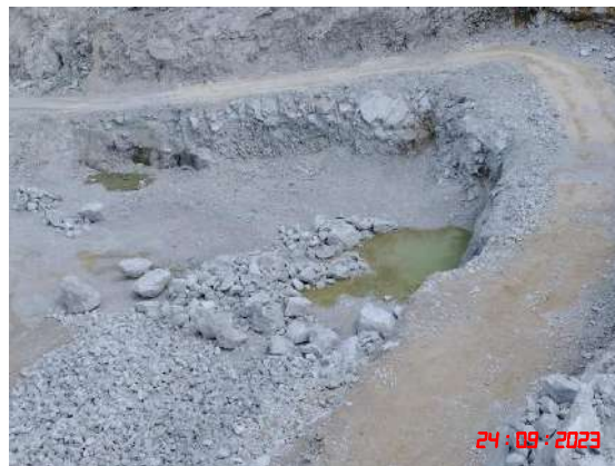
รูปที่ 14 บ่อรับน้ำ (Sump) ชุมเหมือง
